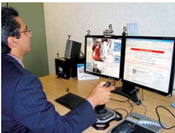
Figura 2. Central remota: 1. Computadora de escritorio. 2. Pantalla doble. 3. Bastón de mando. 4. Teclado. 5. Micrófono. 6. Cámara. 7. Bocinas.
