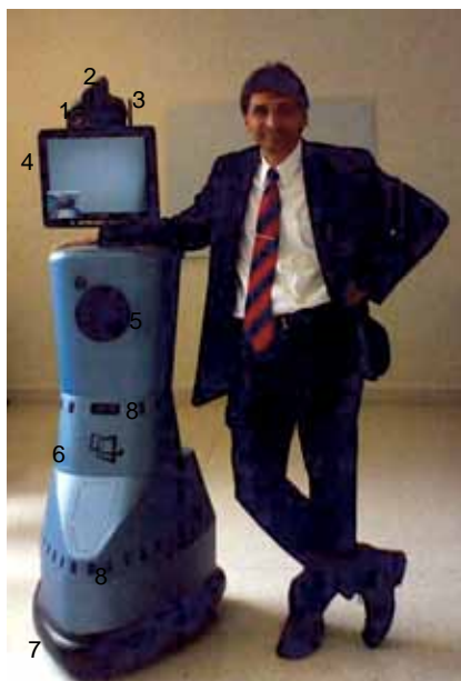
Figura 1. Proporción del robot RP7-i (IntouchHealth®, Santa Barbara, California, USA) en comparación con una persona de 1.70 m de estatura. Las flechas señalan las partes de la que se compone el robot. 1. Cámaras. 2. Micrófono direccional. 3. Antena. 4. Pantalla LCD. 5. Bocinas. 6. Cuerpo del robot. 7. Sistema de locomoción. 8. Sensores de distancia.
