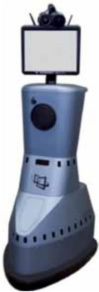
Figura 1. Robot Rp-7i (Intouch Health®) teledirigido mediante internet de banda ancha (para características ver texto).
