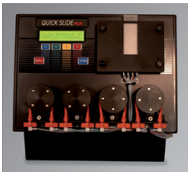
Figura 11. Instrumento para extendido y coloración de sangre periférica. Se muestra un instrumento para hacer y colorear extendidos de sangre periférica independiente del autoanalizador de hematología. Cortesía de GG&B Co, Wichita Falls, Texas.
