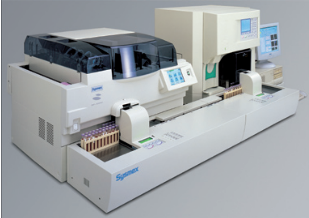
Figura 12. XE-Alpha® de Sysmex. Al lado izquierdo se observa un extensor y coloreador de placas modelo SP-1000i de Sysmex, incorporado al autoanalizador de hematología (DX-2100®) ubicado al lado derecho. Cortesía de Sysmex®.
