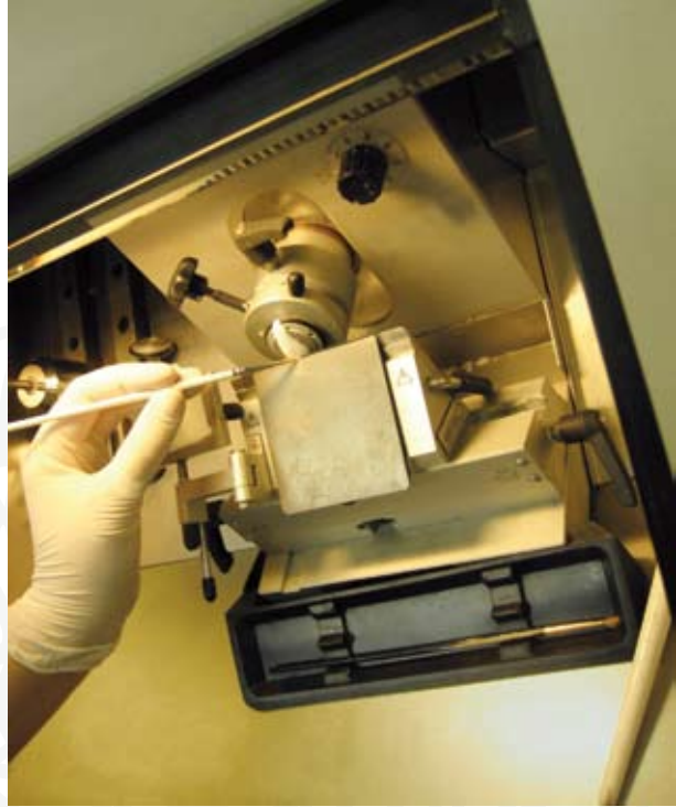
Figura 1. Procesamiento en el criostato. Corte del tejido en el microtomo para la obtención de cortes micrométricos.
