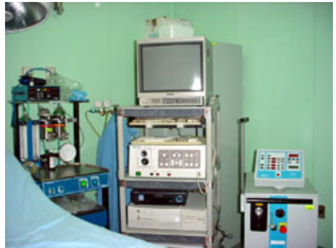
Figura 8. Equipo digital de videobroncoscopia, grabadora, impresora de imágenes y fuente de luz xenón. A un lado generador de láser Nd:YAG. Suite broncoscópica, 2002.
