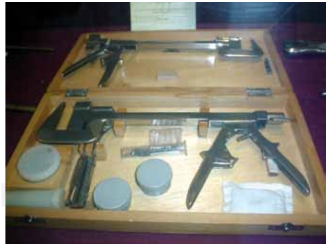
Figura 7. Equipo de engrapadoras automatizadas de origen ruso. Las grapas venían independientes del cartucho. Había que colocar las grapas en el cartucho y montar este último en la engrapadora.
