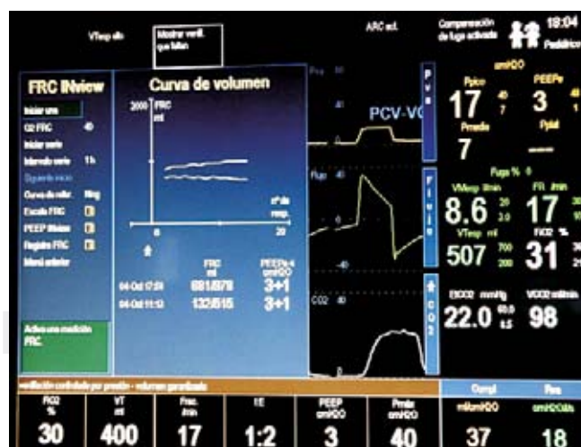
Figura 1. Fotografía tomada de la pantalla del ventilador Engstrom Carestation que muestra una gráfica de volumen-tiempo, en la que se observa el trazo de la medición de la FRC.
