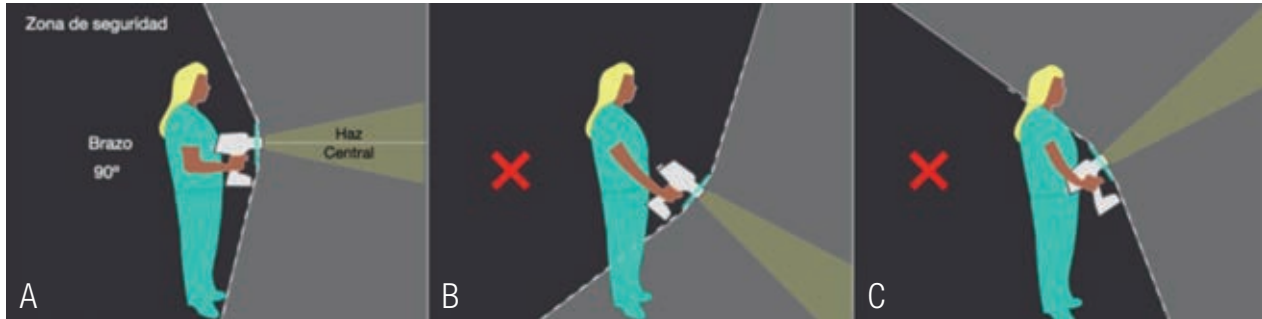
Figura 3. Influencia del ángulo de estabilización del equipo portátil de rayos X: A, Uso correcto del disco de retrodispersión A. con el cilindro localizador paralelo al piso; B. uso incorrecto del disco de retrodispersión con el cilindro apuntando hacia el piso; C. uso incorrecto del disco de retrodispersión con el cilindro apuntando hacia el techo.
