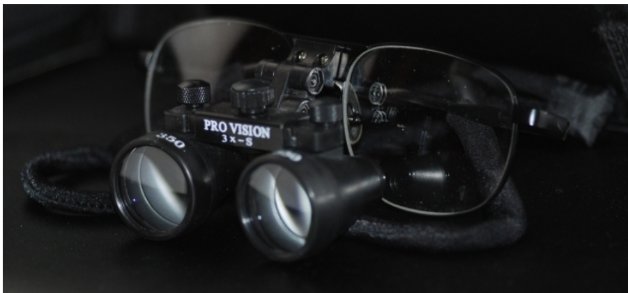
Lentes de magnificación con sistema óptico de kepler. Magnifying glasses with a kepler optical system.
