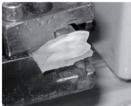
Figura 1. Diente seccionado en sentido longitudinal con una recortadora de precisión lineal (Isomet 5000).
