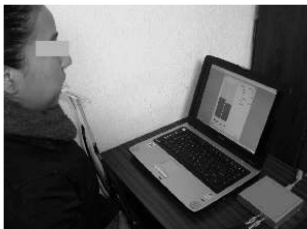
Figura 1. Sistema análogo-digital de fuerza de mordida (bioretroalimentación visual).
