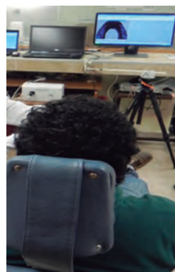
Figura 3. Toma del registro de la Máxima Fuerza de Mordida (MFM) con el T-Scan® EH-2 (Research) y utilizando al mismo tiempo la biorretroalimentación en la que el paciente observa el monitor observando su propia actividad aplicando su MFM.
