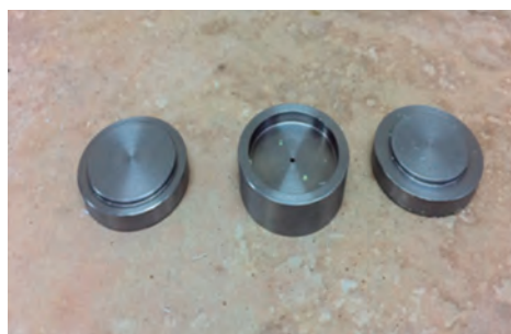
Figura 2. Dado de trabajo con el que se realizaron todas las tabletas para estandarizar el tamaño de todas las muestras con las medidas requeridas (5 mm de grosor x 20 mm de diámetro).
