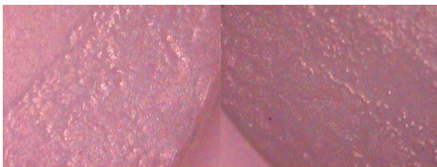
Figura 3. Resina a las 300 horas con rugosidades.
