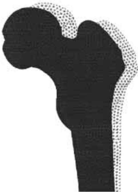
Figura 5. Desplazamientos para el hueso intacto. Las líneas punteadas muestran la posición del hueso antes de aplicar las cargas. El desplazamiento se magnificó 40 veces.
