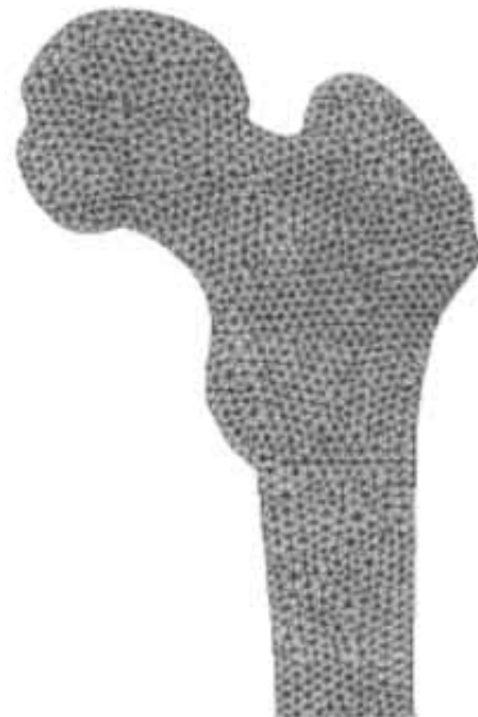
Figura 2. Malla de elementos finitos. 4,829 elementos Plane2 y 10,028 nodos.
