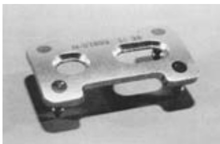
Figura 1. Placa cervical Spineblock, de titanio (Ti6Al4V), con el número de lote y el número de longitud. Se aprecian los cuatro puntos láser que identifican a los cuatro picos. Asimismo, el grosor de la placa de perfil medio (1.2 mm) y los dos orificios de entrada para los tornillos, siendo éstos ovalados y uno de ellos ampliado para darle la característica de una placa dinámica.
