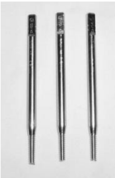
Figura 4. Los 3 tornillos troncocónicos proximales fracturados a nivel de la zona de rosca.
