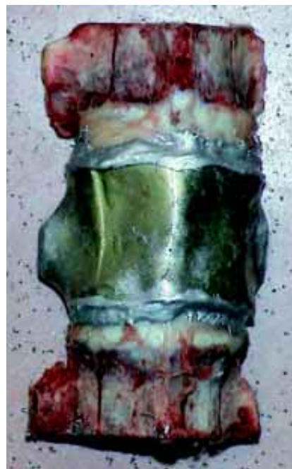
Figura 2. Especimen de prueba conformado con laca fotoelástica.
