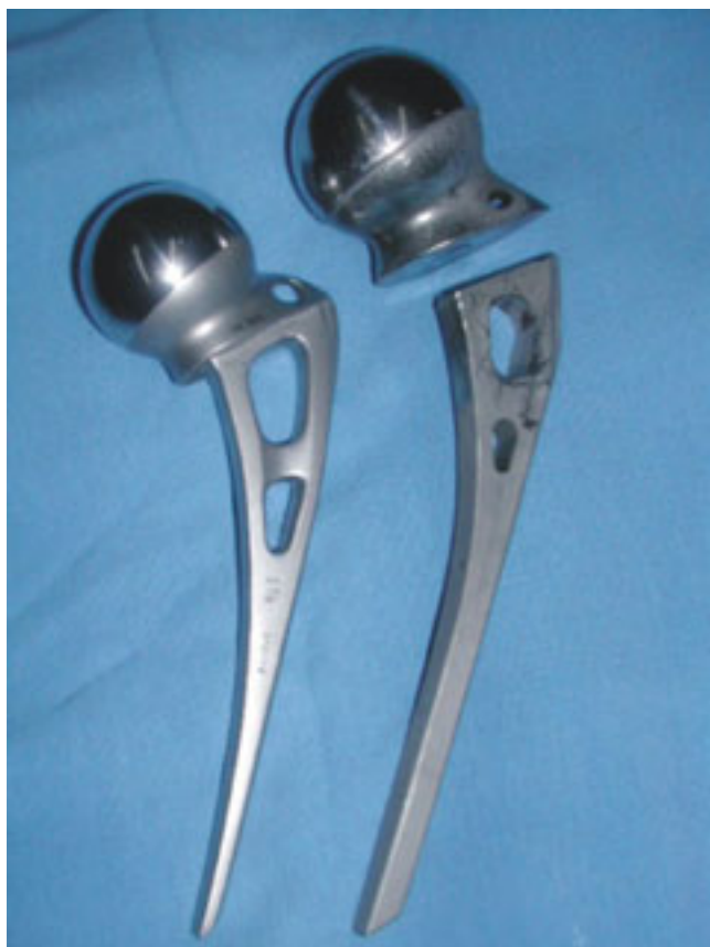
Figura 7. Imagen comparativa de la ruptura de la prótesis de Moore.
