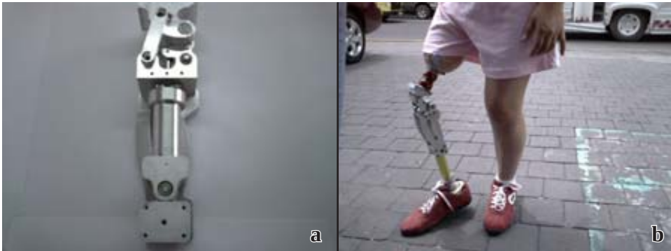
Figura 8. a) Mecanismo policéntrico, actuador mecánico. Zona de inserción del tubo para extensión de la tibia. b) Mecanismo instalado en una prótesis modular de rodilla, tubo de extensión de la tibia, acoplador de mecanismo con extensión en la zona proximal al socket, socket en fibra de vidrio con sistema de succión y pie tipo sach.
