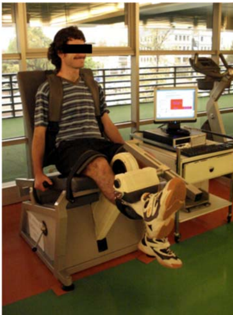
Figura 1. Observamos el desarrollo de una evaluaci3n isocin3tica Cybex 6000 en un paciente reconstruido del LCA derecho. Movimientos de flexi3n y extensi3n de rodilla, realizados de manera c3clica y repetitiva se registran en relaci3n a distintos grados de resistencia ofrecidos por la m3quina, documentando los cambios en Newtons a trav3s de una computadora.
