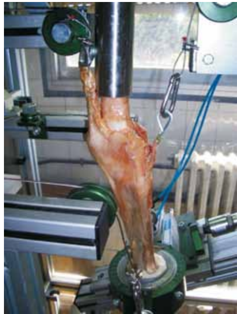
Figura 4. Imagen de una de las rodillas después de instalarla en el simulador experimental.
