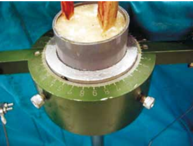
Figura 3. El anclaje tibial se realizaba mediante un cilindro de PVC y resina epóxica.
