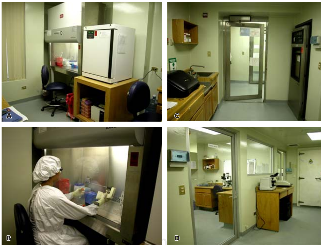
Figura 1. Laboratorio de bioseguridad nivel 3 de la Universidad Autónoma de Nuevo León. A. Cuartos independientes para el trabajo, dentro de los cuales se encuentran campanas de flujo laminar, incubadora de CO 2 y microscopio invertido para el trabajo con cultivo celular. B. Equipo de protección personal para el trabajo en campana: guantes de látex (sin polvo), bata desechable, gorro, cubrezapatos y lentes. C. Doble puerta que permite la regulación de la presión negativa. D. Área de trabajo independiente del resto de los laboratorios con filtros de aire HEPA y presión negativa.
