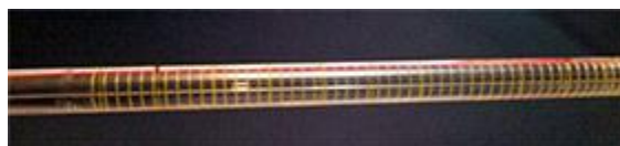
Fig. - Burbuja al interior del tubo milimetrado.
