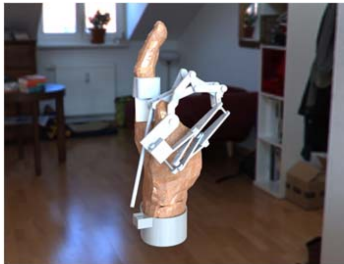
Fig. 23. Vista en perspectiva de la prótesis utilizando Solid Works. Primera implementación de la prótesis ensamblada en la mano.
