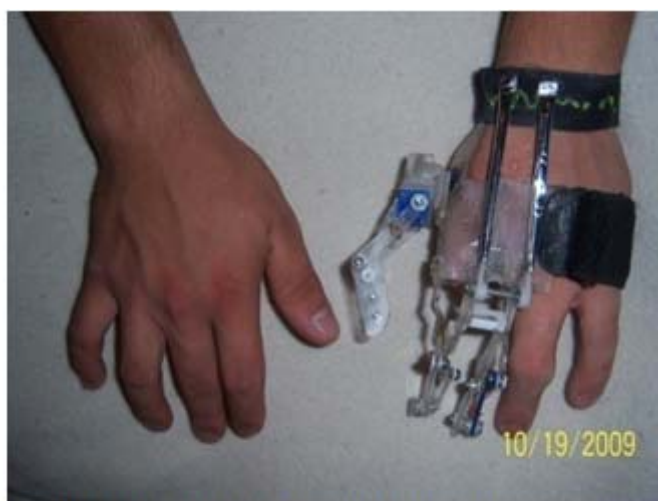
Fig. 28. Vista frontal dorsal de la prótesis prototipo físico versión 0.2. Se observa cómo se conserva la simetría entre ambas manos, así como el tamaño de los dedos índice, medio y pulgar
