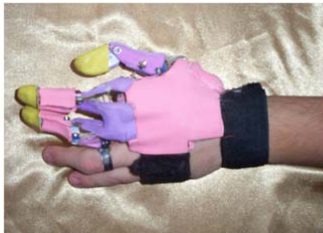
Fig. 30. Vista frontal dorsal de la mano izquierda del usuario usando el prototipo de la prótesis recubierta con EVA.
