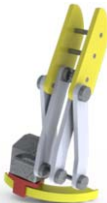
Fig. 18. Vista del pulgar sobre modelado en Solid Works.
