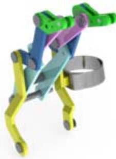
Fig. 17. Dedos índices y medio ensamblados incluyendo el anillo del dedo anular, lo que permitirá accionar los Mecanismos para obtener el movimiento de flexión y extensión deseado.
