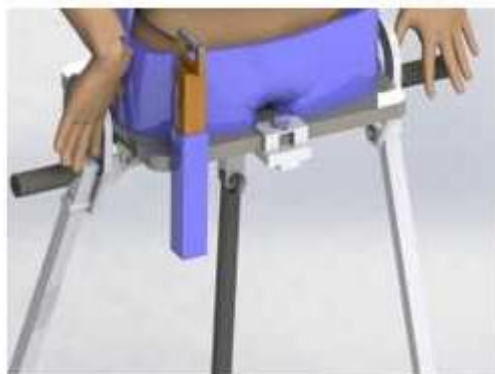
Fig. 2. Sistema de manejo y protección de sobrebalanceo.
