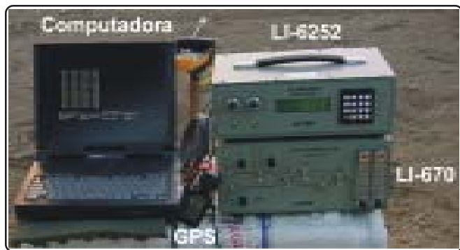
Figura 3. Componentes del sistema de medición: computadora Lap-Top, analizador infrarrojo de CO 2 , unidad de flujo y GPS portátil.
