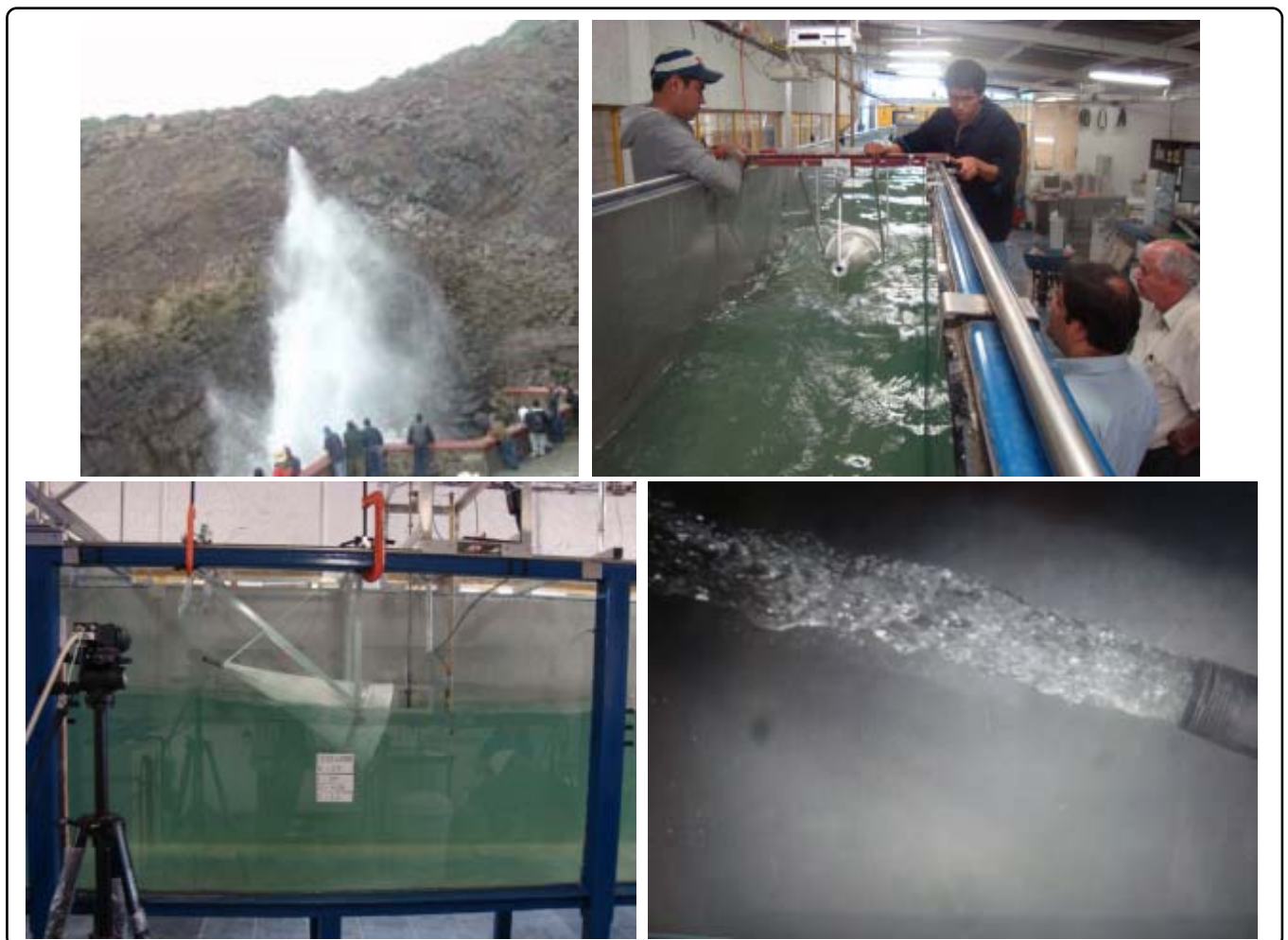
Figura 2. La bufadora, Ensenada, Baja California, y el blowjet probándose en el canal de olas del Instituto de Ingeniería de la UNAM.
