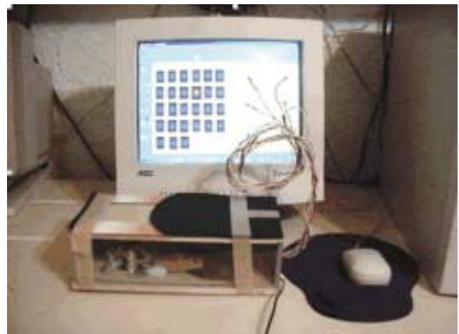
Fig. 10. Prototipo del dispositivo electrónico simulador del código Braille con interfase multimedia interactiva.
