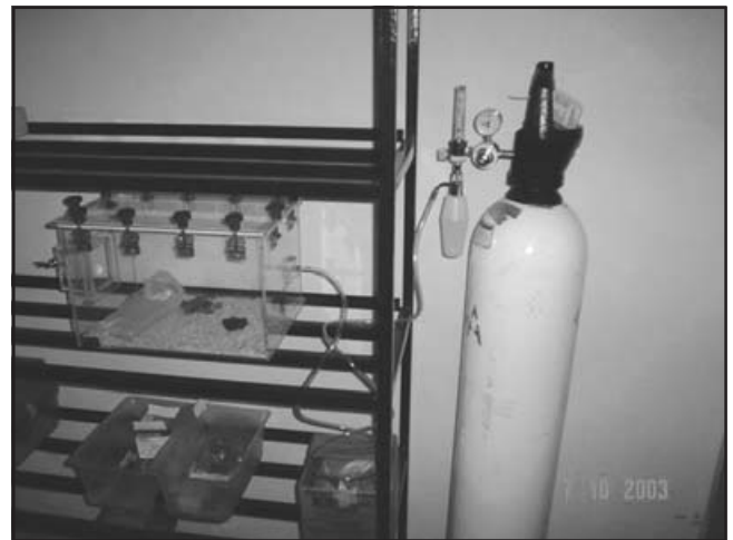
Fig. 2. Caja de acrílico, cerrada herméticamente, con una vía para flujo de entrada donde se conecta el tanque que contiene una mezcla certificada del 75% de oxígeno y 25% de nitrógeno. Al lado opuesto se encuentra la válvula de salida, estableciendo así un microambiente controlado.
