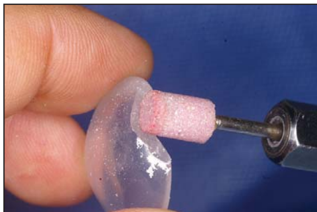
Fig. 4. Corte con piedra montada.
