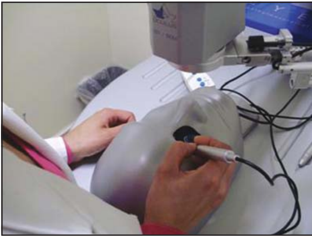
Fig. 1. Mesa móvil motorizada, cabeza de paciente virtual y ojo artificial de EyeSi®.
