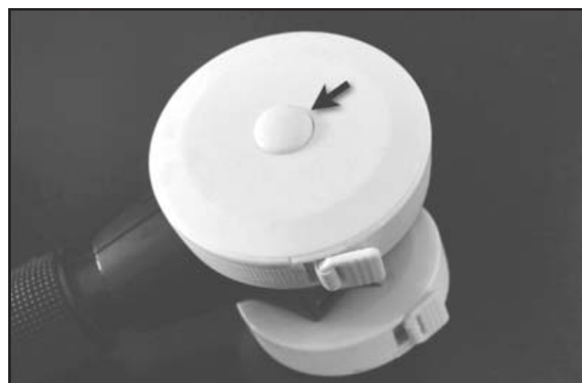
Fig. 6. Se muestran las dos cintas flexibles adaptadas al esquiascopio con el tope integrado para el momento de la medición (flecha).
