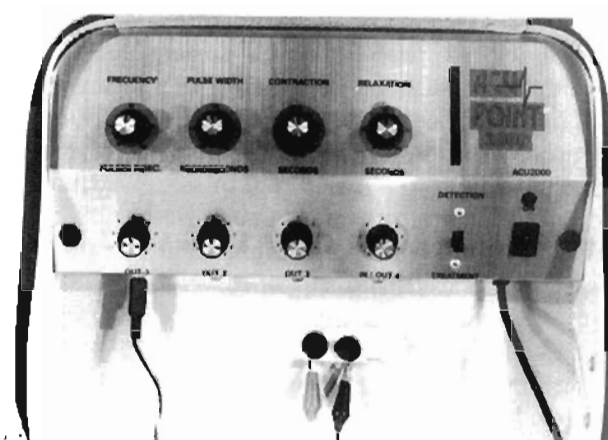
Figura 2. Estimulador Acupoint 2000; en el extremo inferior se muestran los electrodos en un cinturón de Velcro conectados a través de caimanes al estimulador.
