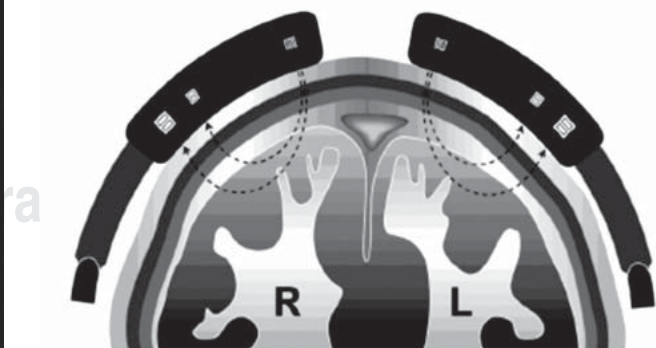
Figura 2. Emisión de luz infrarroja por los sensores del NIRS y trayectoria elíptica de las ondas de luz.
