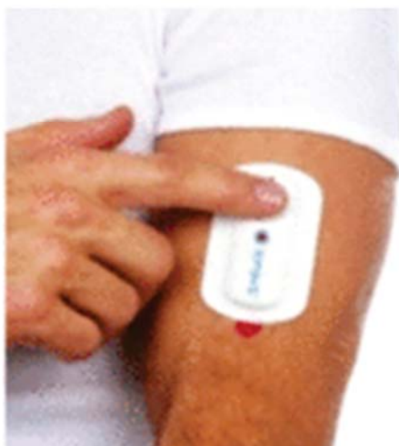
Figura 1. Sistema desarrollado por ALZA Corp. Mountain View, California y comercializado por Janssen-Cilag, denominado IONSYS, consiste en una batería de litio de tres volts, un ánodo de plata en hidrogel que contiene el fentanyl HCL, un cátodo inerte que contiene sustancias inactivas, un botón a demanda para la liberación del fármaco, un diodo de emisión de luz roja (LED) y un dispositivo para su eliminación en la piel.
