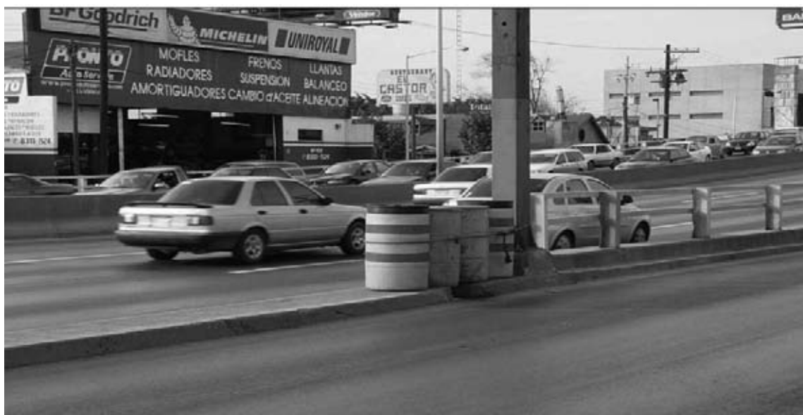
FIGURA 3. EJEMPLOS DE BARRILES DE ABSORCIÓN Y CONTENCIÓN DEL IMPACTO (BAFI) EN LOS QUE SE OBSERVA SU COLOCACIÓN Y SUJECCIÓN
