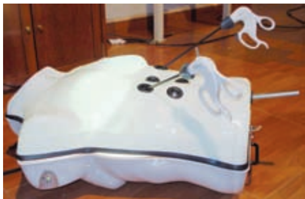
Imagen 1. Simulador inanimado mecánico basado en las condiciones normales del quirófano, una cavidad semicilíndrica que simula la cavidad abdominal con neumoperitoneo, con seis puertos de entrada.
